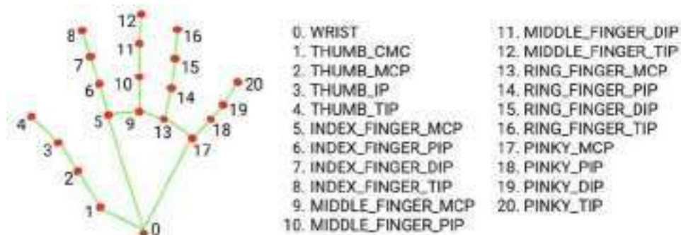
Figura 1: Exemplo de detecção de mãos e indexação dos 21 landmarks pelo MediaPipe Hands ( mediapipe2024 ).
